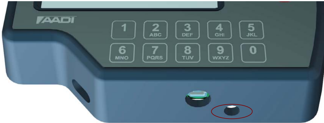
Figur 1-1 Kalibreringsbryteren er plassert på undersiden av hovedenheten.
