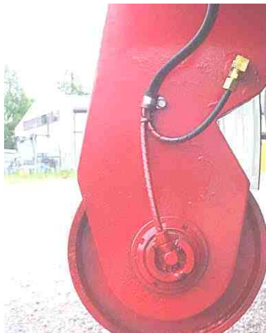
Centralsmörjning framdragen till smörjpunkt
