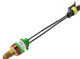
Figur 56. Tryckvakt på kolvackumulator, tryckbrytpunkt = detektorflaska, tryckbrytpunkt 80 bar, matchande kontakt: 69841 = 14 bar, matchande kontakt: 69831. Se även Novec™-system.
