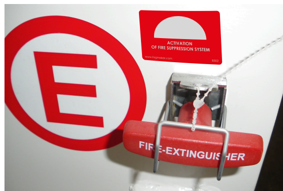
Figur 142. Färdiginstallerat mekaniskt aktiveringshandtag med säkerhetslås. "E" betyder "Extinguisher" (släckare) och är den vedertagna märkning inom racing.
