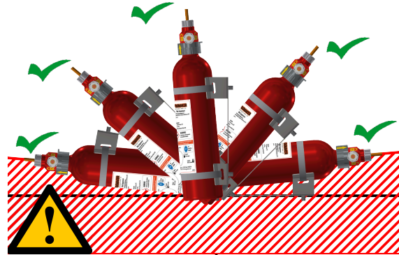
Figur 125. MBSS-flaska, godkända vinklar. Ventilen måste alltid vara vinklad uppåt minst 5°
