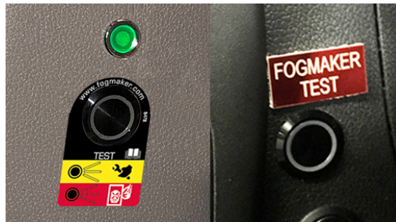
Figur 68. Provningsknapp monterad i instrumentpanelen.
