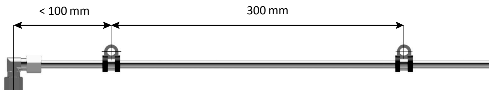
Figur 32. Rör med gummiklamrar.
