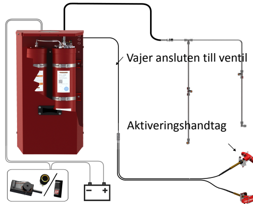
Figur 135. Typiskt brandsläckningssystem med mekanisk utlösning och larm.
