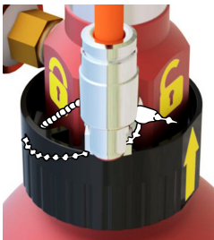
Figur 83. Plombering, detektorflaska (ventil öppen)
