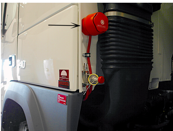
Figur 72. Akustiskt larm placerat på maskinens utsida.
