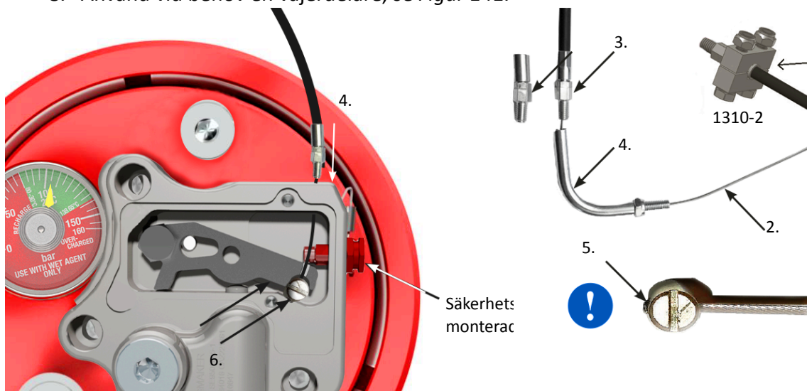
Figur 140. Mekanisk ventil med skyddsplåten borttagen.
