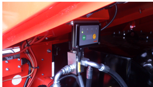
Figur 70. Installerad larmpanel med väggfäste.
