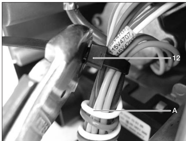
A Två lindningar av glödstiftskablarna till glödstift 1 12 Kabelband (överskjutande bad kortas med en sidavbitare).
