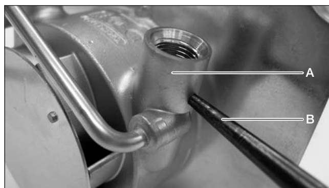
A Höger glödstavsstuts B Spetsigt föremål för rengöring av tändlufthålet.
